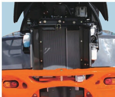
ラジエータとオイルクーラがサイドバイサイド配置で清掃が容易です。
