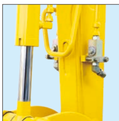
アタッチメント配管/ストップバルブ
