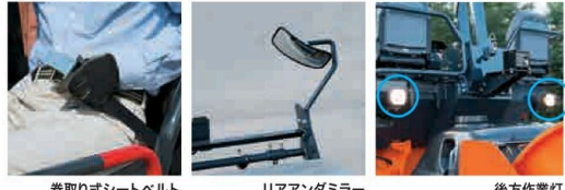
巻取り式シートベルト リアアングミラー 後方作業灯
