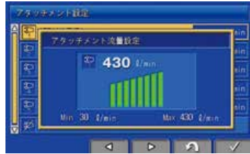
クラッシャなどのアタッチメント (アタッチメントモード時)
