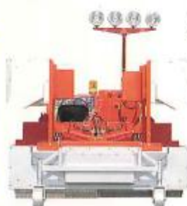
バーナ部は折りたたみためによりコンパクトな設計になっています。
