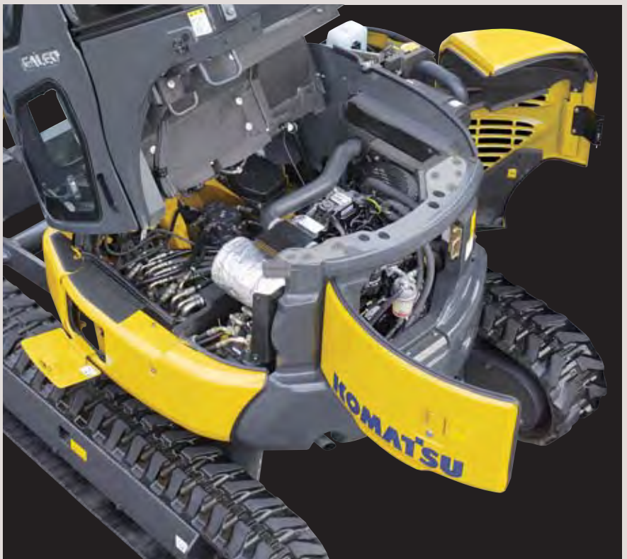
キャブ(エアコン装着)仕様のチルトアップフロア機構&フルオープンカバー
